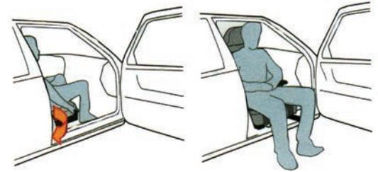
Die Original-Sicherheitsgurte, die sich im Fahrzeug befinden, werden auch weiterhin verwendet. Turnout ist mit der Kennzeichnung CE versehen, crashgetestet und in Übereinstimmung mit den gesetzlichen Vorschriften zugelassen. Es werden nur geringfügige Veränderungen am Auto vorgenommen, die leicht behoben werden können, bevor das Fahrzeug wieder verkauft wird. Turnout kann für das nächste Fahrzeug verwendet werden.
